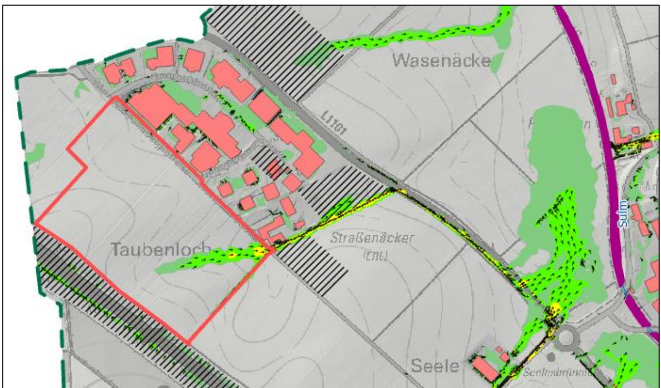
Abbildung 6: Die Fließgeschwindigkeit im Bereich „Innovationsquartier Straßenäcker“ für das Szenario „selten“ mit eingezeichnetem Abgrenzungsplan des NGBs. Die Farbgebung stellt von grün über gelb nach rot die Fließgeschwindigkeiten „0,2 – 0,5 m/s“, „0,5 – 2 m/s“ sowie „> 2m/s“ dar. Die Fließrichtung ist anhand der schwarzen Pfeile dargestellt.
