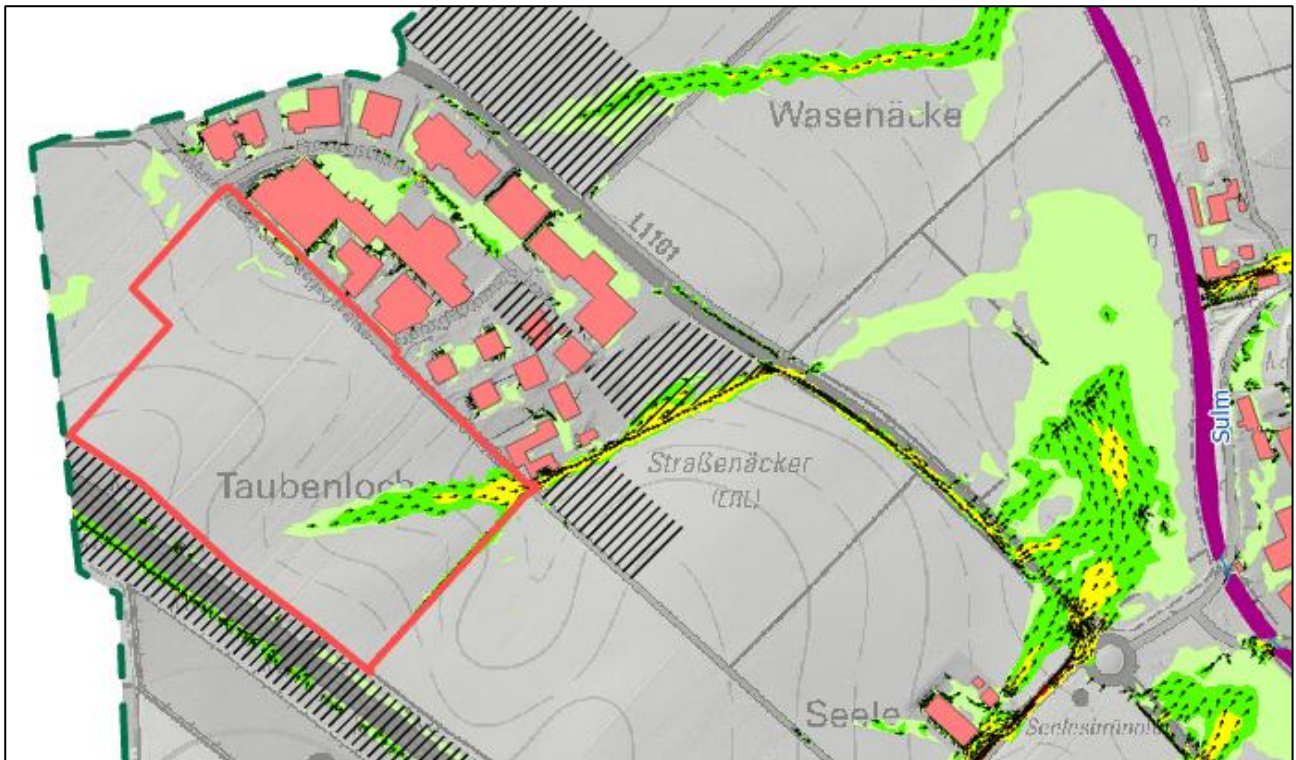
Abbildung 7: Die Fließgeschwindigkeit im Bereich „Innovationsquartier Straßenäcker“ für das Szenario „außergewöhnlich“ mit eingezeichnetem Abgrenzungsplan des NGBs. Die Farbgebung stellt von grün über gelb nach rot die Fließgeschwindigkeiten „0,2 – 0,5 m/s“, „0,5 – 2 m/s“ sowie „> 2m/s“ dar. Die Fließrichtung ist anhand der schwarzen Pfeile dargestellt.
