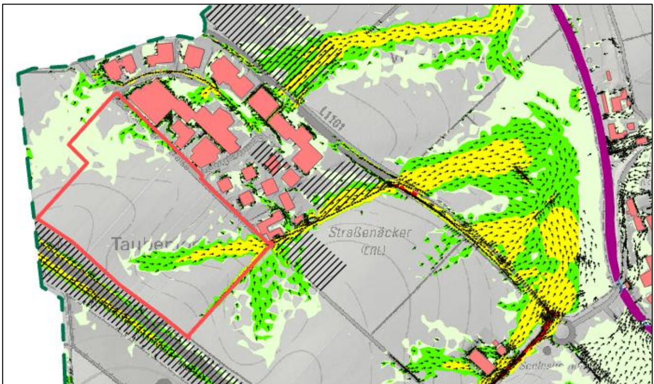
Abbildung 8: Die Fließgeschwindigkeit im Bereich „Innovationsquartier Straßenäcker“ für das Szenario „extrem“ mit eingezeichnetem Abgrenzungsplan des NGBs. Die Farbgebung stellt von grün über gelb nach rot die Fließgeschwindigkeiten „0,2 – 0,5 m/s“, „0,5 – 2 m/s“ sowie „> 2m/s“ dar. Die Fließrichtung ist anhand der schwarzen Pfeile dargestellt.
