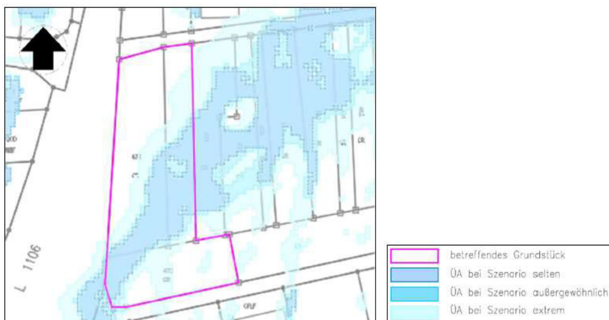
Abb. 4: Überflutungsflächen im Bereich der Flurstücke Nr. 474 und 475 (Quelle: IB Schöll Consult)
